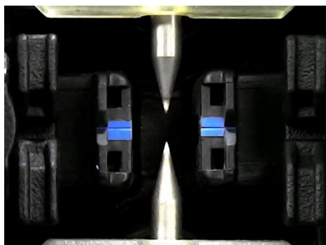
Presencia de oxido de silice en electrodos
