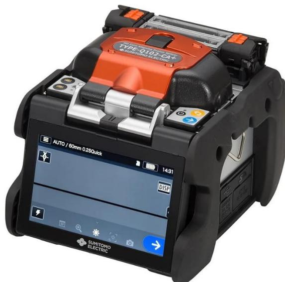
La fusionadora TYPE-Q102-CA+ inspecciona y alinea dos fibras ópticas de una fibra automáticamente con microscopios y luego las fusiona con el calor que produce un arco eléctrico para formar un empalme de baja pérdida.
