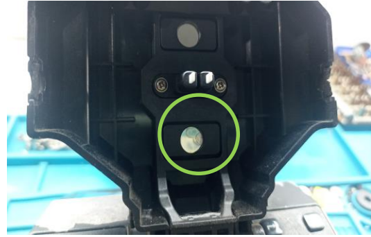
Suciedad en espejo de tapa cubierta
