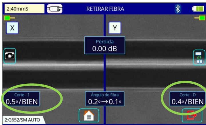
Img 2 Se sugiere que el ángulo de corte debe estar por debajo de los 5°
