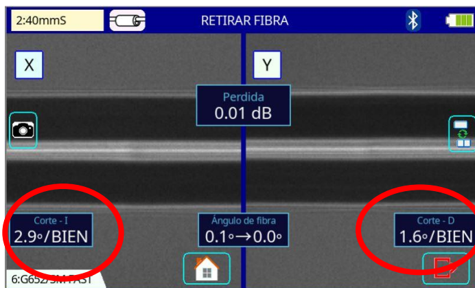
Img 1 en la siguiente imagen podemos observar que los ángulos de cortes están elevados.
