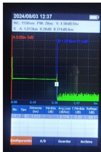
Img 4 Medicion correcta en la longitud de 1550nm
