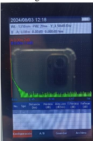
Img 1 Sin medición de fibra
