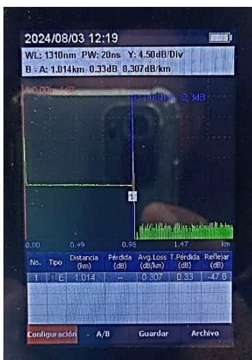
Img 3 Medicion correcta en la longitud de 1310nm
