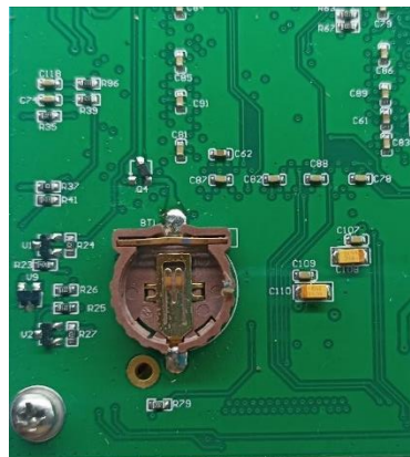
Img 2 Ausencia de bateria
