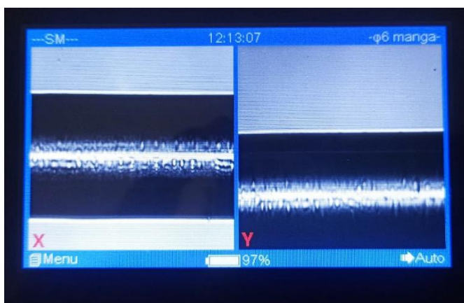
Img 4 Camaras descentralizadas
