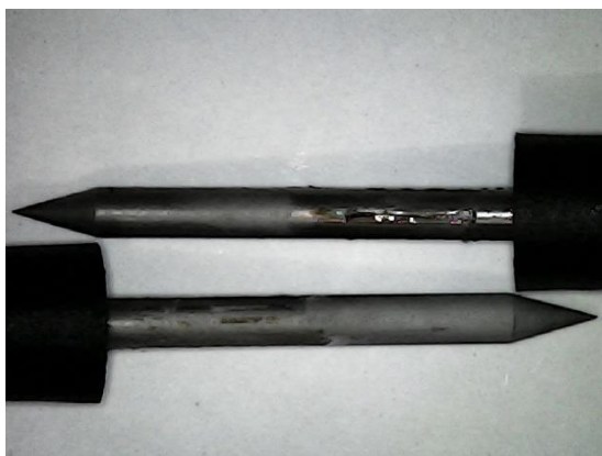
Img 2 Electrodos con presencia de oxido
