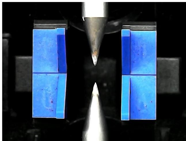
Img 1 Presencia de oxido de sílice en electrodos
