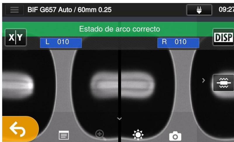
Img 3 Calibración de arco OK.
