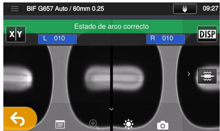
Img 4 de arco OK
