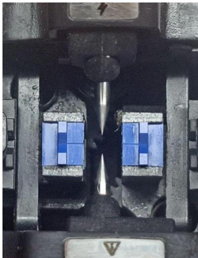
*Img 3 Limpieza de electrodos*
