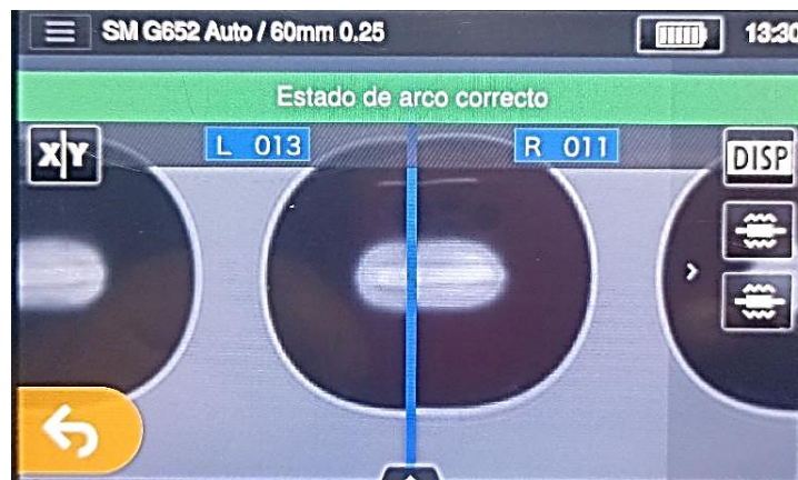
Img 9 Test de arco OK
