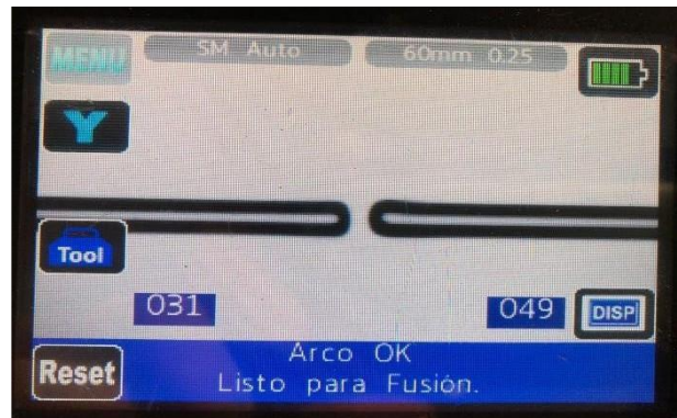
Img 4 Calibración de arco completada
