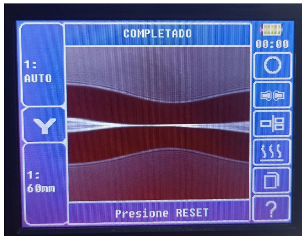
Img 3 Test de arco OK
