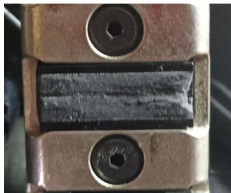
Img 2 Desgaste de elemento de sujeción de la fibra
