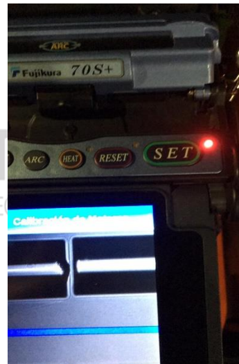
Img 4 Correccion de suciedad en camara
