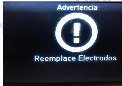
Img 2 Advertencia de reemplazo de electrodos
