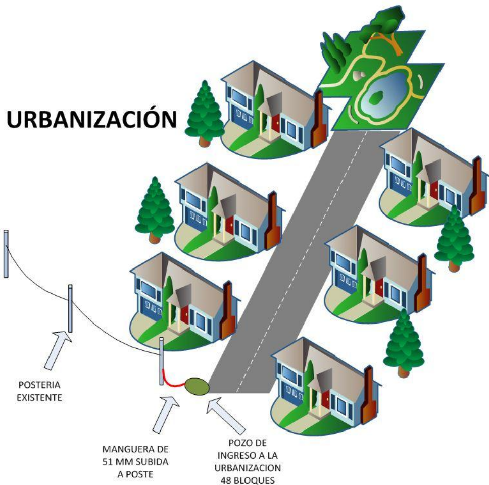
Fig. 6. Subida a poste desde el pozo de ingreso a la Urbanización
