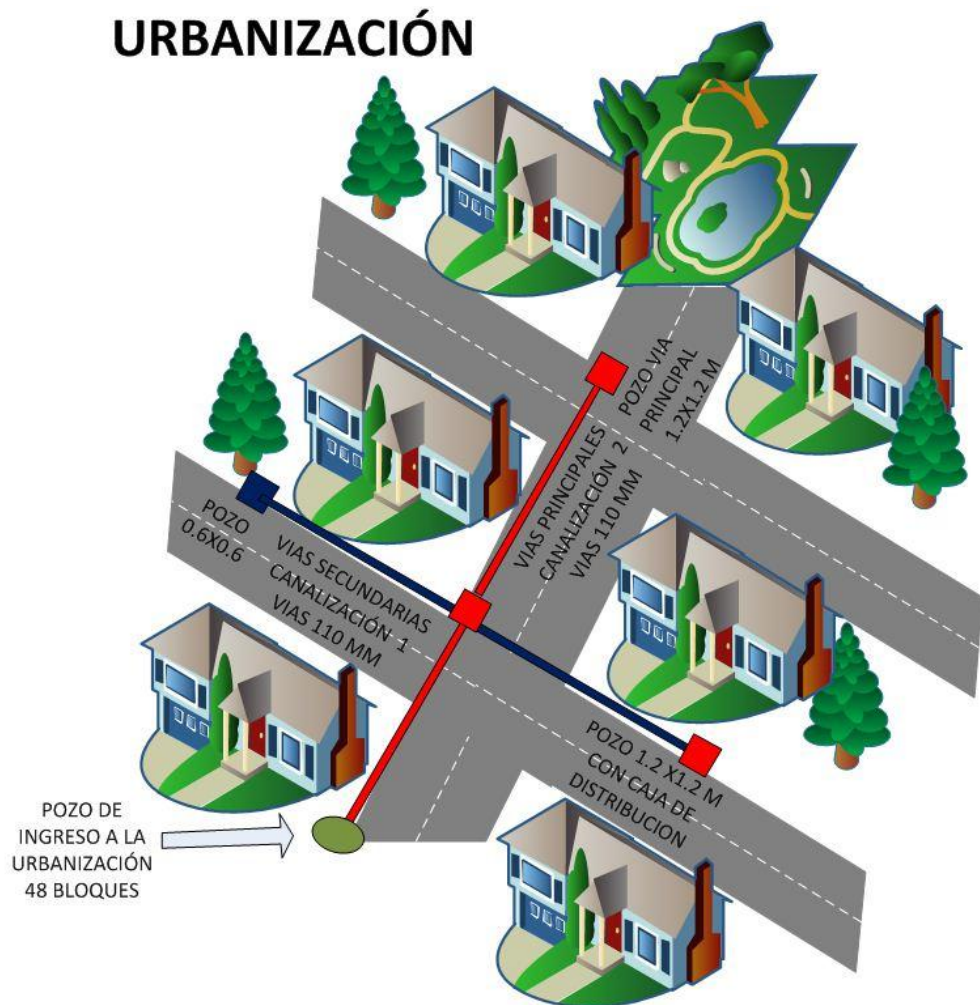
Fig. 8. Canalización interna en Urbanizaciones
