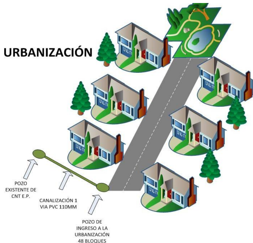
Fig. 5. Pozo de ingreso y canalización a Urbanizaciones
